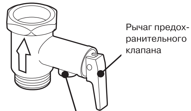
Выпускное отверстие предохранительного клапана
